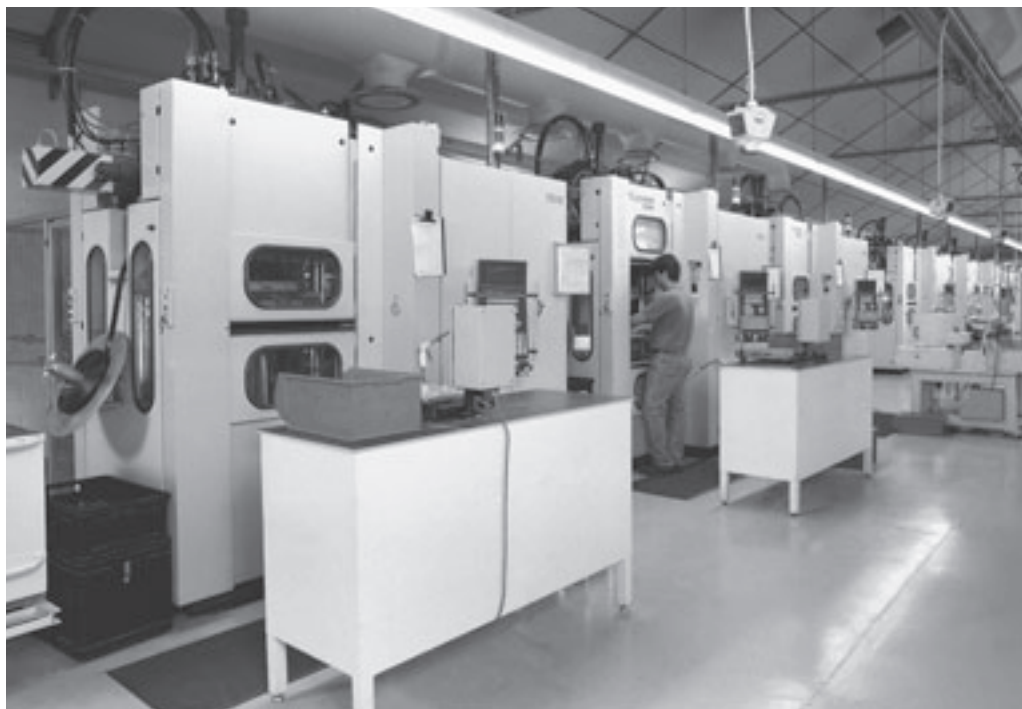
Moderne Fertigungstechnologie: vertikale Gummi-Spritzgießmaschinen State-of-the-art manufacturing technology: vertical rubber injection machines
